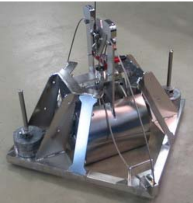
Figure 7.2-5 : Benne de type Day-Grab (SOURCE : TBM, 2009).
