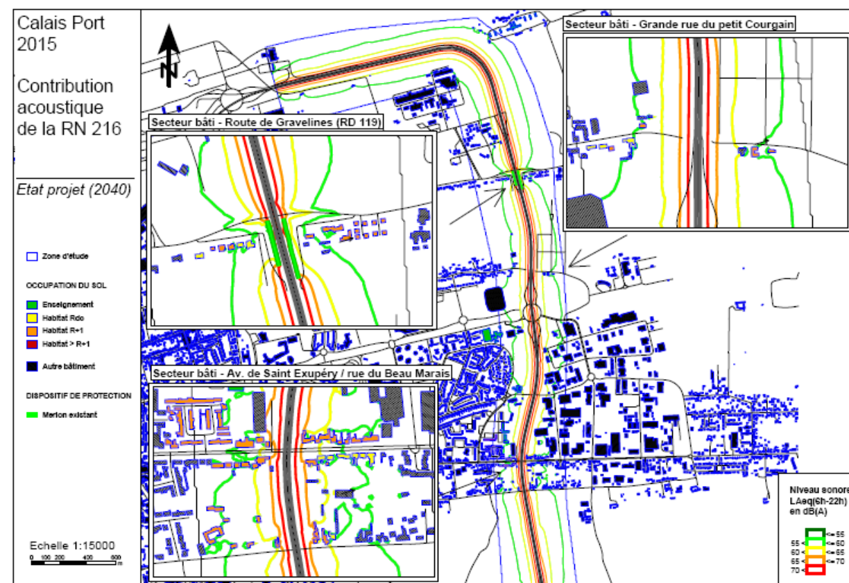
Figure 5.1-4 : Zones d'émergence sonores le long de la rocade Est en configuration de projet 2040 pour la période 06H-22H (Source : SCE, 2011)
